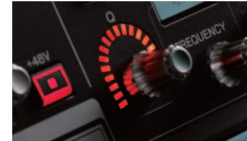
我们在设计上做出了巨大努力，确保提供给工程师的操作反馈始终清晰如一，以便他们做出合适的混音决策。通道条顶部多功能编码器周围环绕的“马蹄环型”指示灯也经过精心设计，站在工程师的视角，每个段落都完全可见。尤其是在现场混音的情况下，每一处细节都很重要。
