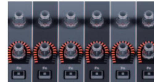
RIVAGE PM10 和 PM7 控制界面为每个通道配备两个编码器：可分配给五个不同功能的通道条编码器，以及控制相邻显示板上相应参数的屏幕编码器。当涉及到实际操作时，物理控制器实力拔群，因此每个通道上的两个编码器的可用性为 PM10 和 PM7 增添了操作上的优势。
