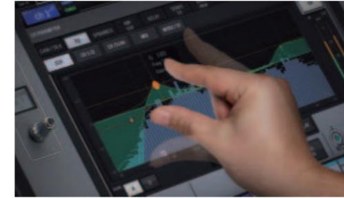
RIVAGE PM5 的许多非凡功能都浓缩于三块 15 英寸电容式触摸显示屏中。这些大型的高可视性显示屏以清晰、有序的结构集中显示必要的控制和信息，使工程师能以最快速度和效率查看并应对各种情况。触控灵敏度不仅支持基本的点击和选择，还可使用熟悉的捏合和滑动手势，显著提升操作效率。
