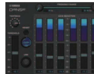
RIVAGE PM 系列拥有一系列强大的雅马哈原装插件，其中包括 DaNSe 噪声抑制器。“DaNSe”插件可以分析噪声频率特性，并采用 LEARN 功能自动实现最有效的噪声抑制，无需用户进行任何复杂的设置或编程。对于戏剧和音乐剧来说，噪声抑制的优势非常显著，可大幅提高音频清晰度。DaNSe 还能有效地抑制空调噪音，以及舞台移动灯中冷却风扇产生的噪音。它还能减少监听音箱对舞台上的乐器话筒造成的影响，并在广播和体育赛事中抑制人群噪声。它是一种高效、应用广泛的噪声抑制工具。
