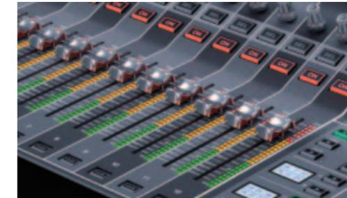
与每个推子相关的电平表也具有清晰的视觉反馈。推子电平表可以显示单声道或立体声电平，或者用户可以查看通道动态处理器的衰减电平。推子电平表提供直接的反馈，让用户了解推子操作是如何影响信号，从而使用户实现精确的控制。
