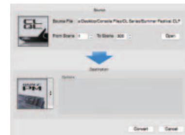
Yamaha Console File Converter (雅马哈调音台文件转换器) 是一款非常实用的应用软件。用户可以实现 RIVAGE PM 系列、CL/QL 系列、PM5D、M7CL 和 LS9 调音台之间的数据共享，即使使用完全不同的调音台，一台设备中的参数数据也无需彻底重新编程就能复制到另外一台上并使用。
