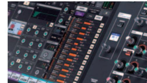
设置发送是几乎所有现场混音流程中的重要部分。除了熟悉的 Sends on Fader（推子发送信号）功能外，用户可以通过 Send / User Defined（发送 / 用户定义）旋钮控制发送电平。也可以通过触摸控制调整显示屏面板上出现的发送电平。这种扩展的控制选择范围显著提升了设置和调整发送时的方便性和通用性。
