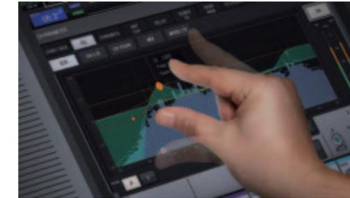
这款高可视性 15 英寸显示屏以易于理解的布局将必备的控制和信息融为一体，工程师能够快速高效地读取和应对各种情况。触控灵敏度不仅支持基本的点击和选择，还可使用熟悉的捏合和滑动手势，显著提升操作效率。显示屏与广为熟知的雅马哈选定通道部分联动，提供紧凑的必备物理控制，实现快速、直观的动手操作。
